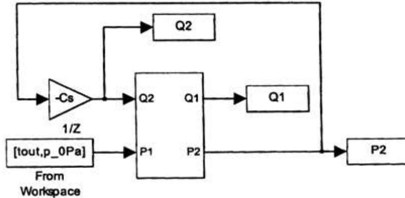
Fig. 3: Simulink model
