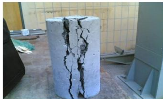
(d) Rubberized concrete after test
